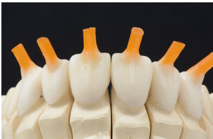
Peças com seus devidos canais de alimentação fixados
